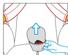
E. Entfernen Sie den 5-Punk-Sicherheitsgurt und anschließend den Überzug der Kopfstütze und der Sitzschale.
