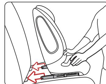
C. Afferrare il seggiolino per comprovare se è assicurato saldamente o se si muove. Se il seggiolino si muove e i connettori ISOFIX si sfilano, ripetere tutta la procedura indicata anteriormente e installarlo di nuovo.
