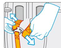
B. Lösen Sie die Sicherheitsgurte und ziehen Sie den Gurt aus dem Gurtbügel, wie in der rechten Abbildung dargestellt.
