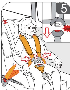
D. Ziehen Sie den Sicherheitsgurt fest, indem Sie an den Riemen ziehen und befestigen Sie die Kopfstütze in der richtigen Höhe. Achten Sie dabei darauf, dass Ihr Kind sich wohl fühlt. (Abbildung 6)
