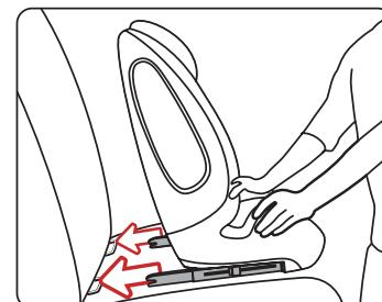
C. Agarre a estrutura da cadeira para verificar se está firmemente preso ou balança. Se o cadeira estiver a balançar e os fixadores ISOFIX estiverem puxados para fora, repita os passos acima e instale-a novamente.
