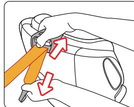
E. Accrochez le crochet de la sangle de fixation sur les ancrages prêts à l'emploi. Vérifiez s'il y a 3 ancrages pour le crochet, veuillez en trouver un qui vous convient.
