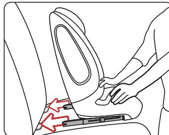
C. Presione los conectores ISOFIX directamente en sus anclajes hasta oír "CLICK".
