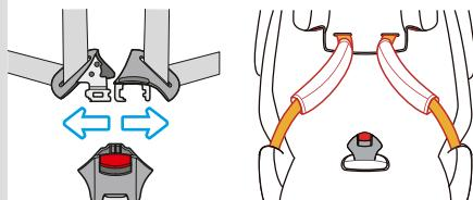
C. L'altezza corretta del supporto per le spalle è ottenuta quando la cintura sparisce nel guscio del seggiolino poco sopra le spalle del bambino. Assicurarsi che le bretelle siano correttamente posizioionate sopra le spalle del bambino.
