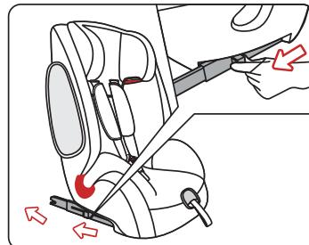
B. Drücken Sie die ISOFIX-Konnektoren direkt in die Haltebügel, bis sie mit dem Geräusch „Klick“ korrekt eingerastet sind.
