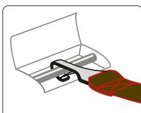
F. Retirez la sangle de fixation sur une autre extrémité pour serrer la top tether.
