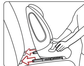
C. Rütteln Sie am Sitz, um zu überprüfen, ob er richtig befestigt ist und nicht wackelt. Sollte der Sitz nachgeben und sich die ISOFIX-Konnektoren aus dem Haltebügel gelöst haben, wiederholen Sie die oben genannten Schritte und befestigen Sie die Konnektoren erneut.
