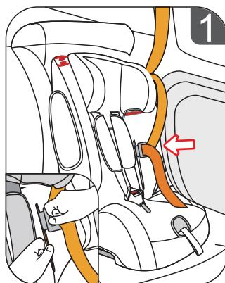
B. Por favor asegúrese de que el cinturón del vehículo pase por la guía roja en la parte superior trasera de la silla y que el cinturón ventral no se doble. Después de la instalación, tense el cinturón en la dirección que indica la flecha (imagen 4)
