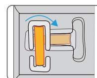
D. Anschließend ziehen Sie den kompletten Gurt aus dem Unterteil des Sitzes. Drehen Sie die Schnalle in die dargestellte Position und entnehmen Sie sie dann der Sitzschale.
