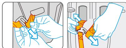
C. Estrarre due bretelle dai fori del rivestimento, poi separare le bretelle con la fibbia del connettore metallico.
