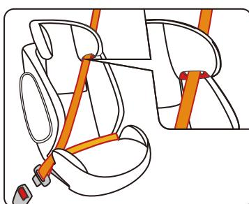
B. Inserire la cintura per la spalla
